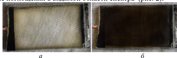
Рис. 2. Электрохромная ячейка: а – обесцвеченное; б – окрашенное состояние
